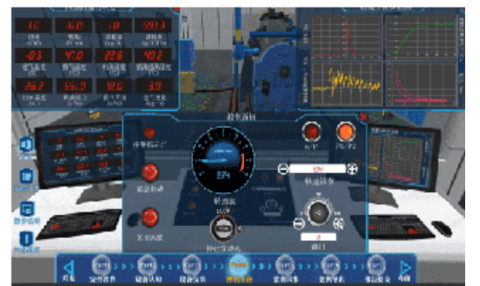
“内燃机性能测试”虚拟仿真实验操作界面
